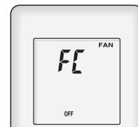
Si aucun bouton n'est pressé dans les 30 secondes suivant l'affichage de l'état « FC », le système revient à l'affichage original de l'horloge. Dans ce cas, recommencez depuis l'étape 1.
