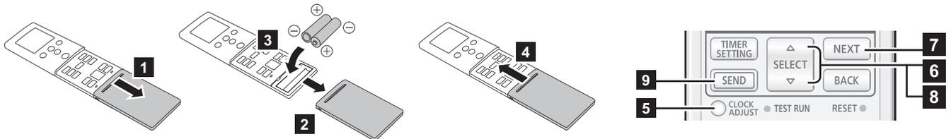
**5** Appuyez sur la touche CLOCK ADJUST (RÉGLAGE HORLOGE) pour commencer le réglage de l'horloge.
